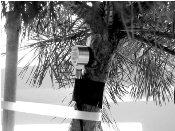
**Abbildung 1.** Sensor zum Messen der Ultraschallsignale in Bäumen. Im Bild eine Walliser Föhre im Laborversuch.
