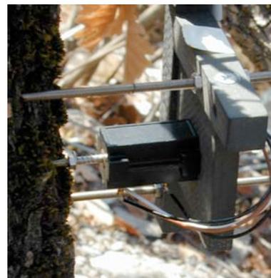
**Abbildung 3.** Dendrometer sind elektronische Messgeräte, die kontinuierlich den Stammradius messen. Daraus lassen sich der Rindenwassergehalt und das Jahringwachstum eines Baumes ableiten.
