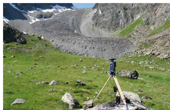
Abb. 7: DGPS Referenzstation auf einem Fixpunkt vor dem Reichenkar Blockgletscher (Österreich). Foto: K. Krainer
