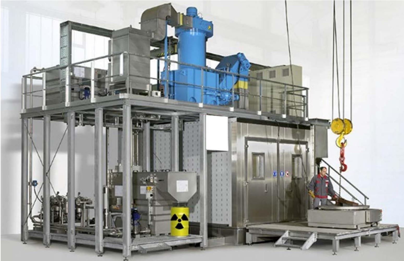
Die **Nassstrahlanlage**: Ein Beispiel einer abgeschlossenen Arbeitsbox mit gefilterter Abluft
