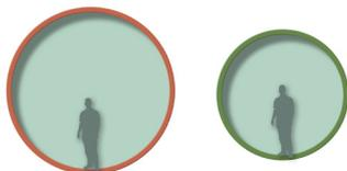
Mit 4,3 m Durchmesser ist der neue Stollen grösser als der bestehende Stollen mit 3,3 m Durchmesser. Dadurch fliesst in den beiden Stollen das Wasser langsamer, was zu weniger Reibungsverlusten führt.
